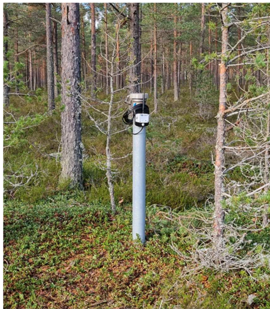
Kuva 1/Bild 1. Jatkuvatoininen pinnanmittaus havaintoputkessa/Kontinuerlig ytmätning i observationsröret
